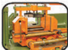
Alimentação automática hidráulica [Apenas nos modelos automáticos]
