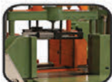
Pressa feixe com regulagens telescópicas, vertical e horizontal, para ajuste de diversas dimensões de feixes
