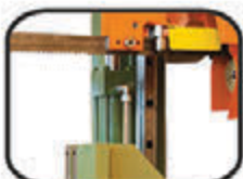
Basculante apoiado verticalmente sobre guias lineares
